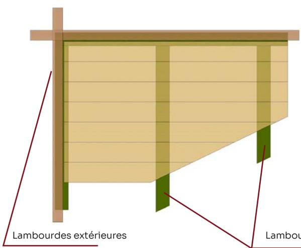
Châssis de fondation y compris les planches de 19 mm
